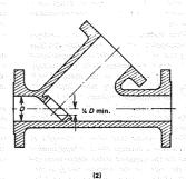
FIG. 122.1.7(C) TYPICAL GLOBE VALVES
