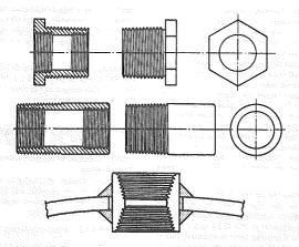
FIG. PG-59.1 TYPICAL BOILER BUSHINGS
