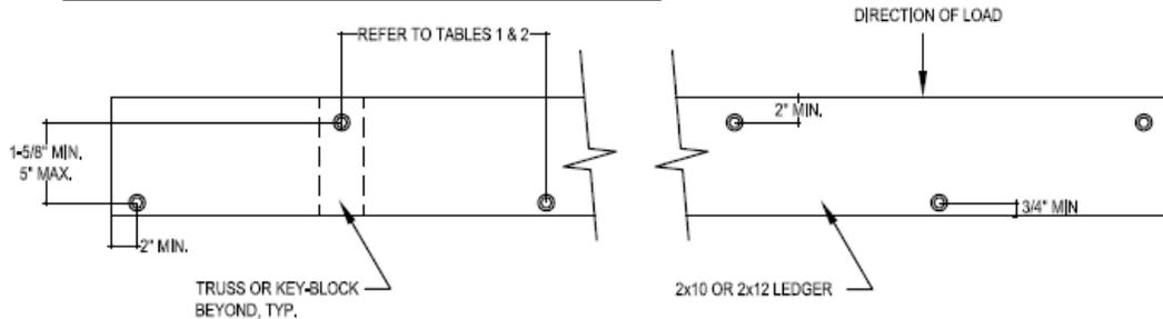
**KEY-BLOCK DETAIL FOR LEDGER ATTACHED TO END OF TRUSSES**
