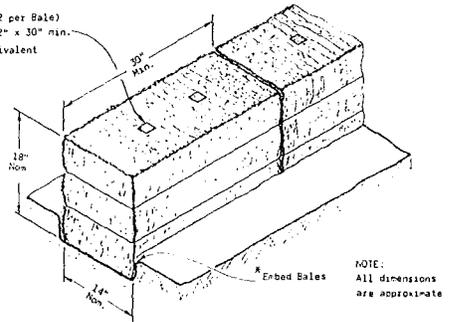
DETAIL OF EROSION BALE INSTALLATION
