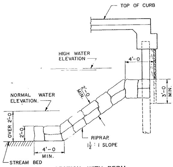
LONGITUDINAL SECTION WITH BERM
