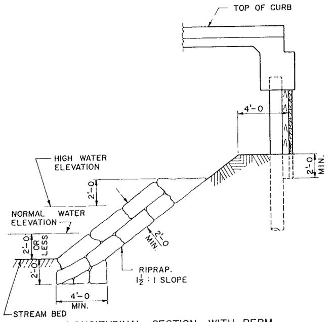
LONGITUDINAL SECTION WITH BERM
