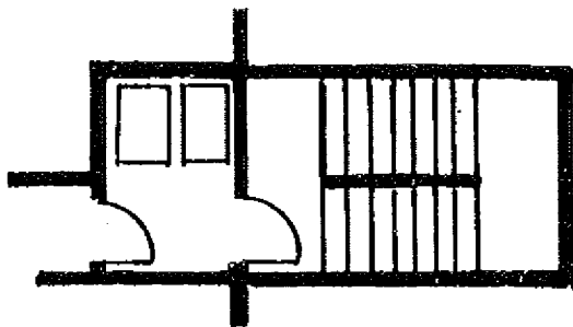
ILHR 69.23 (3) (d) VESTIBULE/RATED STAIR
